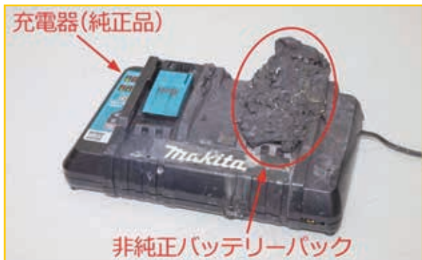
* 上の写真は純正品の充電器に社外品のバッテリーを充電していた時に発火したもの
