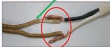
素線数(太さ)の違う電気コードの接続
